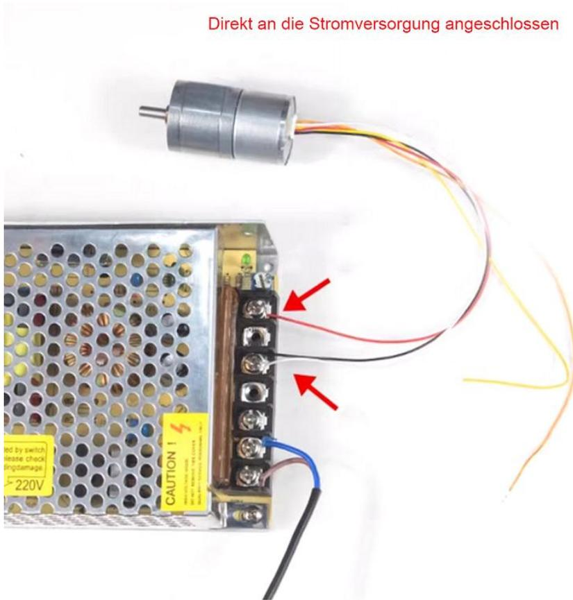
Verbindungsmethode: Verbinden Sie den roten Draht mit dem positiven Pol und den schwarz-weißen Draht mit dem negativen Pol.
