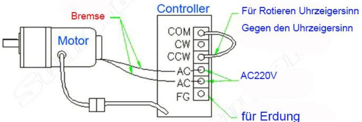
**Bremse Fundamental:** Beim Einschalten der Bremse verschwindet der Widerstand. Beim Ausschalten der Bremse wird die Bremse die Motordrehung bremsen. Wenn alle Stromkreis geschlossen wird, wird die Bremse den Motor nicht beeinflussen, Wenn der Stromkreis geöffnet wird, wird die Bremse sofort die Motordrehung bremsen
