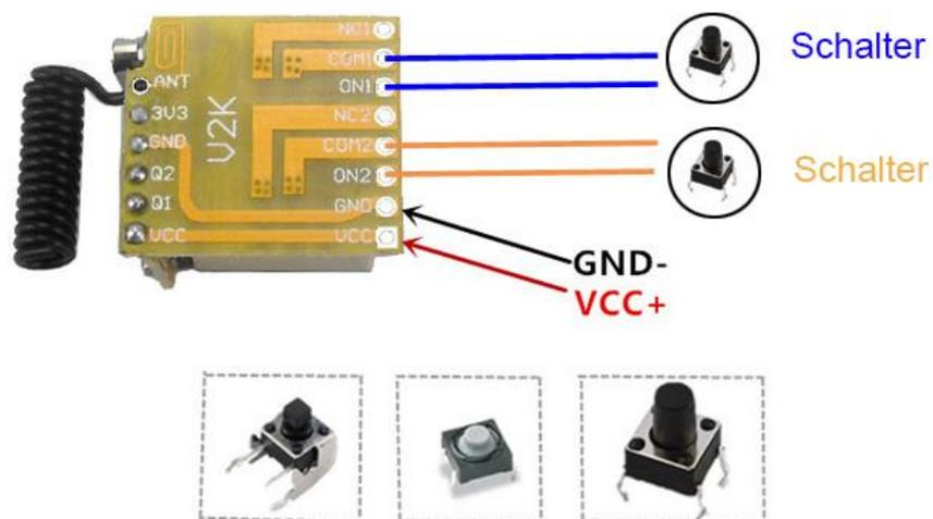
Eingang DC3,7V bis 24V, Ausgang 0V Schaltwert
