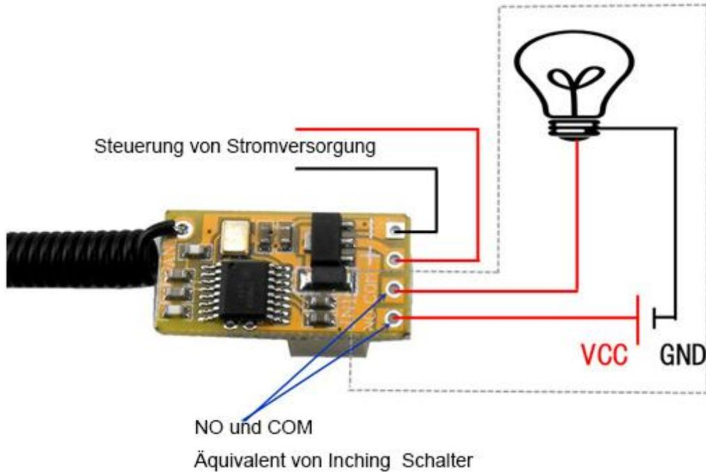
Inching Schalter Probe Figure Controller für 1 Sekunde Verzögerungsreaktionszeit
